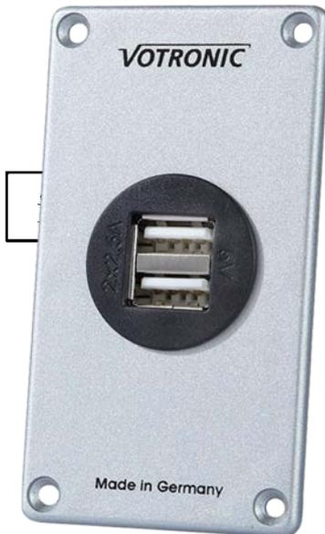
Das USB-Lader-Panel S beinhaltet 2 USB-Ladebuchsen mit je 2,5 A maximalem Ladestrom zur Aufladung von USB-ladefähigen Geräten, wie z.B. Smartphone oder Tablet. Es ist für den Betrieb an 12 V- oder 24 V-KFZ-Bordnetz vorgesehen.
